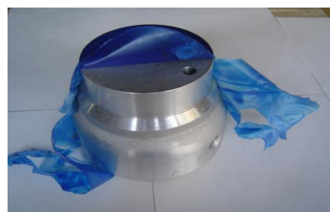
乾燥後の簡単はく離状態
