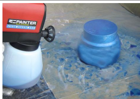
電動ミニペインターによる 吹き付け塗装
